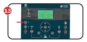
FR: Pour un groupe raccordé en démarrage «secours» appuyez sur le bouton « ». Le groupe ne démarrera qu'en cas de coupure du réseau local.
