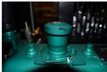
Fig 3.2 Remplissage huile moteur
